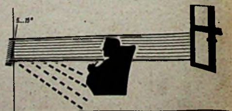
Bild 3. Waagrecht einfallendes Störlicht kann durch eine leichte Neigung des Bildschirms unschädlich gemacht werden.
